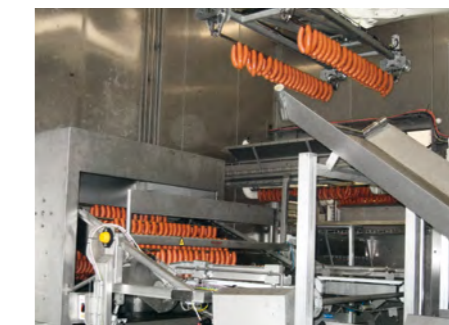
Ausgabe von Würsten zum direkten Transport zur Verpackung.
