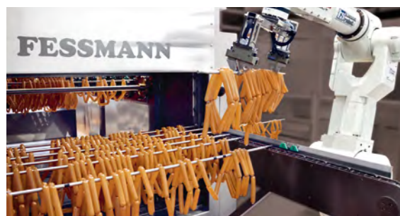
Automatische Roboter-Beladung vom Füller zur TF4000.
