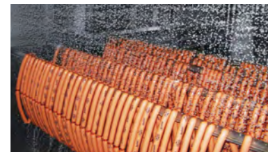
Wasserdusche zum Abspülen von Brätpartikeln als Hygieneschutz.
